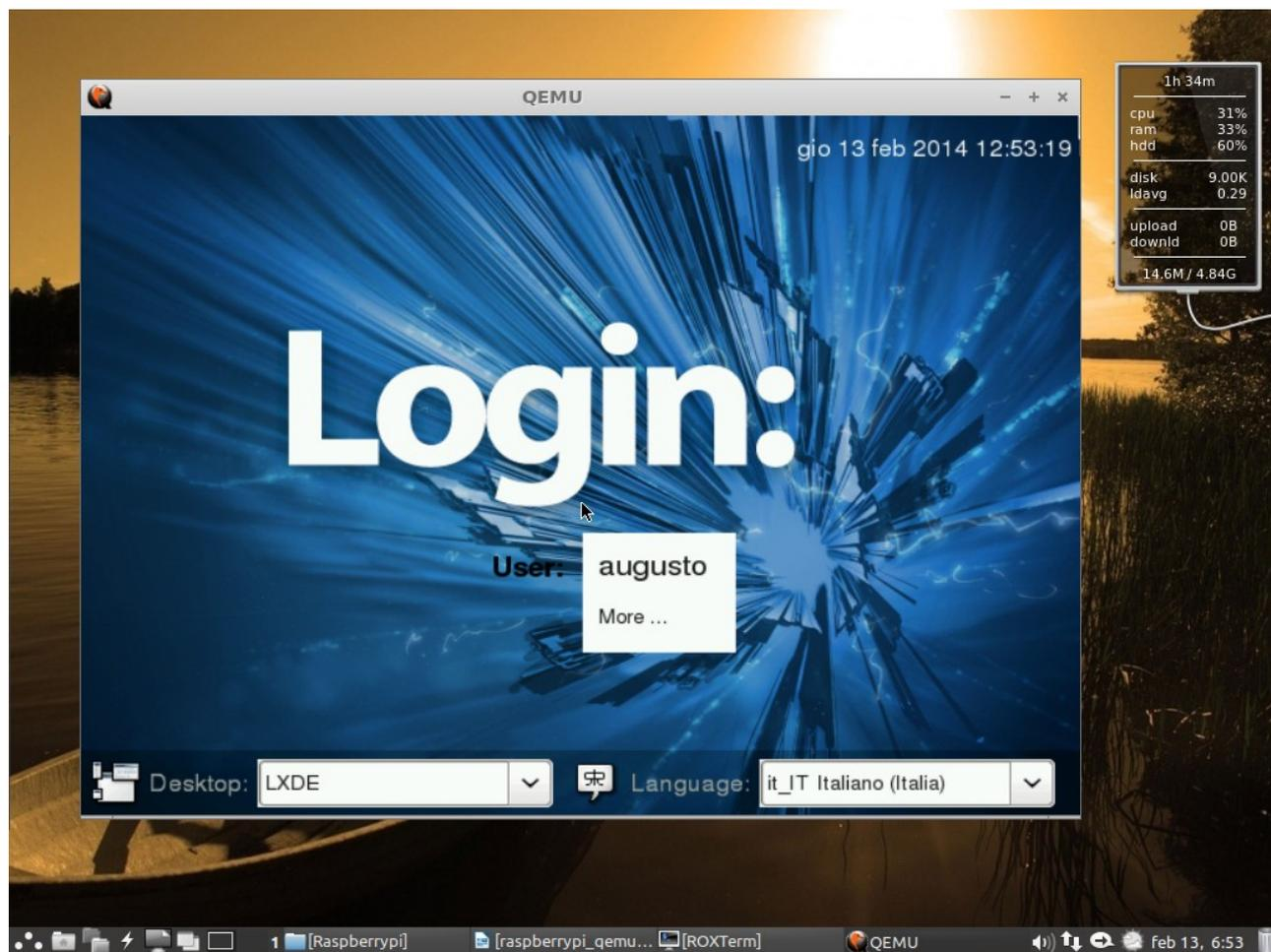
L'esercizio consiste nel virtualizzare un RaspBerry pi tramite Qemu su una macchina equipaggiata con Lubuntu LXLE a sua volta virtualizzata tramite VirtuaBox su una macchina fisica con Ubuntu.
